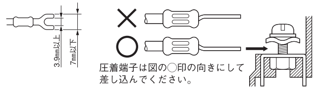
適正締め付トルク [1 ~ 1.2N · m (約 11kgf · cm)]
