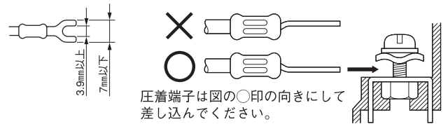
適正締付トルク [1 ~ 1.2N · m (約 11 kgf · cm)]
